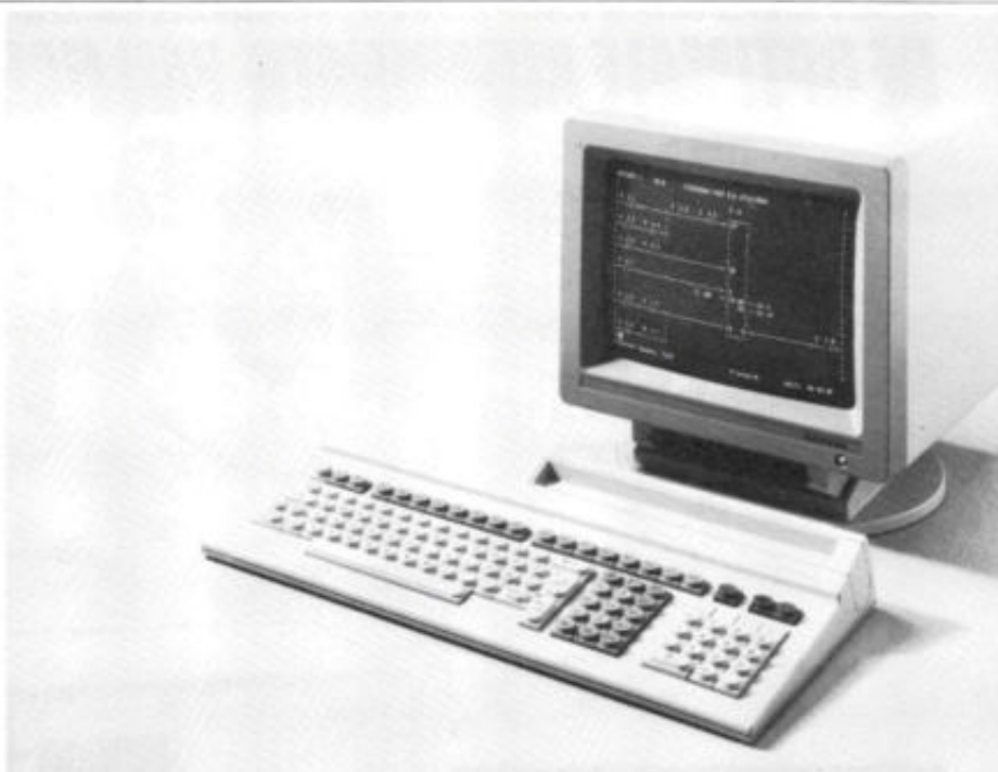
Afb. 2. Stationair programmeerstation PG 695. Op dit station kunnen langs grafische weg besturingsprogramma's in de vorm van functieschema's en aansluitschema's worden opgesteld. Voorts kunnen programma's in de vorm van instructieoverzichten worden uitgeschreven. Het softwarepakket COM525 dient voor het menubestuurd opstellen van de dynamische voorgrondpresentatie ten behoeve van de communicatieprocessor. Met behulp van de programma's COM 530 en COM 535 kunnen programmeerbare besturingseenheden in netwerkverband over de Siemens LAN Sinec H1 communiceren.
