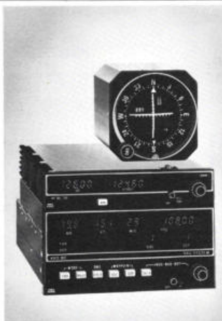
Afb. 4. VOR-radionavigatiesysteem, bestaande uit een display en een navigatiecomputer. (foto: King Radio Corp.)
