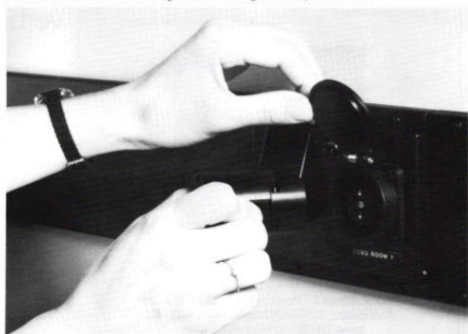
Afb. 1. Op het PHILAN-ringnet kunnen apparaten worden aangesloten, variërend van telefoons tot computers. Voor het maken van deze aansluitingen is een robuuste optische wandcontactdoos met bijbehorende stekker ontworpen, waarmee twee glasvezels kunnen worden doorverbonden (voor de in- en de uitgaande leiding van elk apparaat). De glasvezels zijn afgewerkt met zgn. ferrules, metalen busjes met een diameter van 2,5 mm, waarvan het buitenoppervlak concentrisch is afgedraaid met de ca. 100 \mu m dikke kern van de glasvezel. Door geleidemechanismen worden de beide ferrule-paren nauwkeurig tegenover elkaar gebracht. De stekker maakt eveneens de elektrische verbindingen voor besturing van het optische relais.
